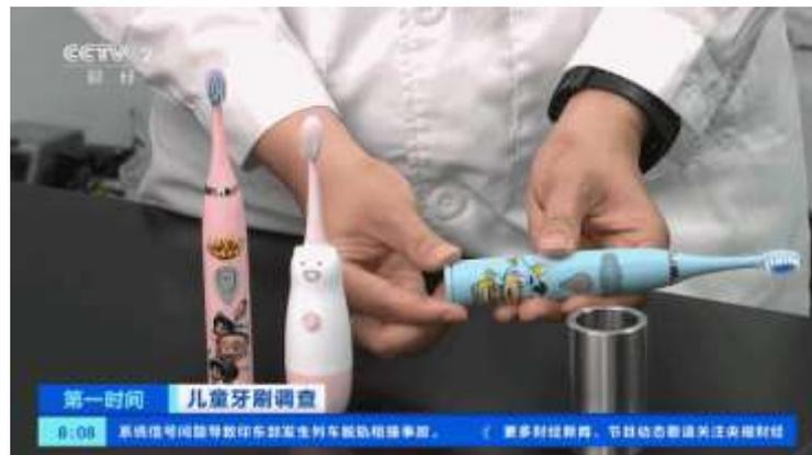
這是小零件試驗筒，類比兒童咽喉的尺寸。這些能夠完全放入試驗桶的刷頭和電池外殼都是可能造成兒童誤吞的危險小零件。按照牙刷國標規定，供三歲以下兒童使用的電動牙刷不允許存在小零件；適用於三歲及以上不足六歲的兒童使用的電動牙刷，如果存在小零件，應設警示說明。
